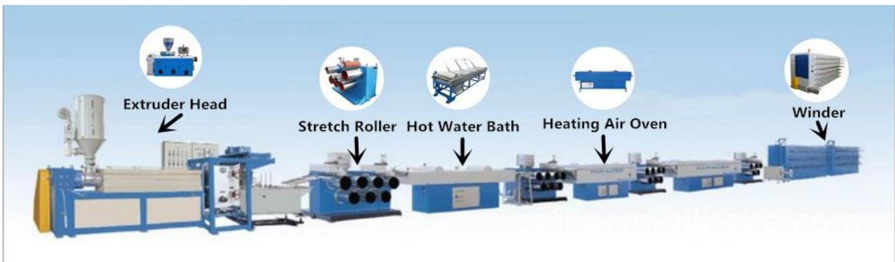
Figure 2 : Procédé d'extrusion de monofilaments
